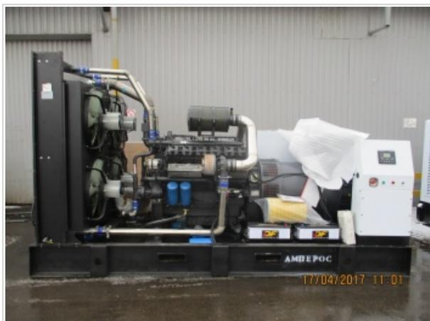
Дизель генератор максимальной мощностью - 1238 кВА/990 кВт, основная мощность 1125 кВА/900 кВт. Дизель KÖGEL 12V.
