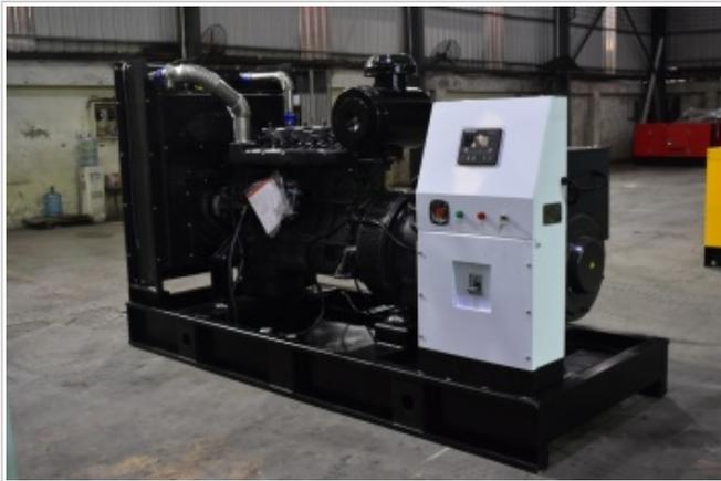
Дизель генератор мощностью 100 кВт / 110 кВт. Дизель 6-цилиндровый Ricardo R6105AZLD 1500 об/мин жидкостного охлаждения.
