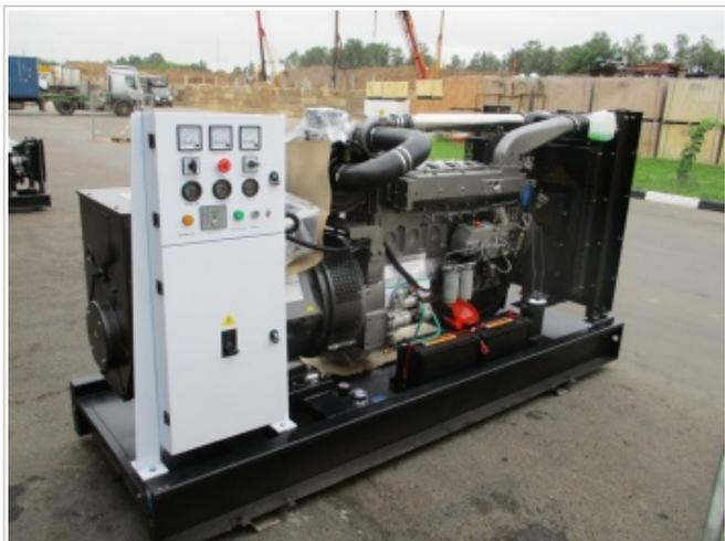
Дизель генератор мощностью 240 кВт / 264 кВт. Дизель KÖGEL 1500 об/мин жидкостного охлаждения.
