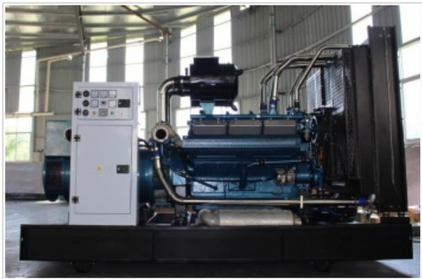
Дизель генератор максимальной мощностью - 688 кВА/550 кВт, основная мощность 625 кВА/500 кВт. Дизель KÖGEL 1500 об/мин.
