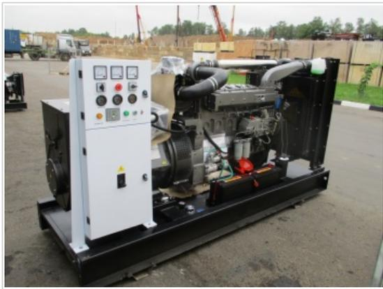
Дизель генератор мощностью 220 кВт / 240 кВт. Дизель KÖGEL 1500 об/мин жидкостного охлаждения.
