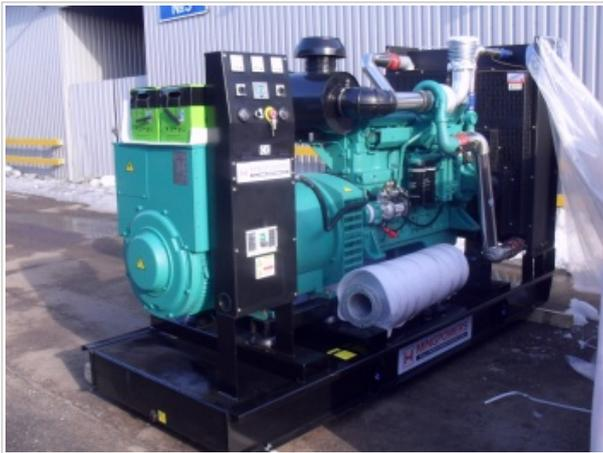
Дизель генератор основной мощность - 625 кВА/500 кВт, резервная мощность - 688 кВА/550 кВт. Дизель CUMMINS.
