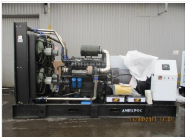
Дизель генератор максимальной мощностью - 1030 кВА/825 кВт, основная мощность 930 кВА/750 кВт. Дизель KÖGEL 1500 об/мин.
