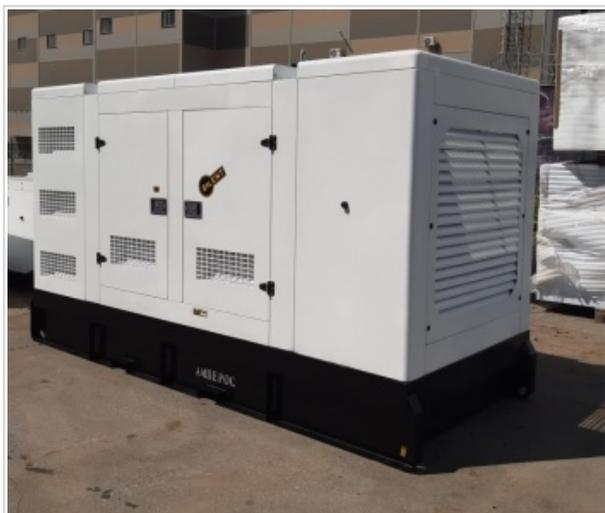
Дизель генератор номинальной мощностью - 375кВА /300 кВт, максимальной мощностью - 413 кВА/330 кВт. Дизель SDEC.
