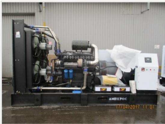
Дизель генератор мощность - 2000 кВА/1600 кВт. Дизель KÖGEL 12V.
