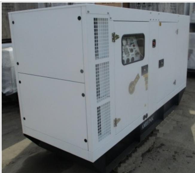
Дизель генератор мощностью 160 кВт/176 кВт в шумозащитном кожухе. Дизель Iveco-FPT (Италия) 1500 об/мин жидкостного охлаждения. Дизель генератор для интенсивной эксплуатации.
