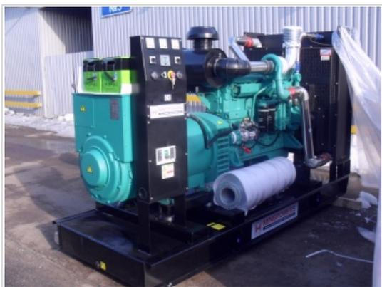
Дизель генератор основная мощность - 500 кВА/400 кВт, резервная мощность - 550 кВА/440 кВт . Дизель CUMMINS .
