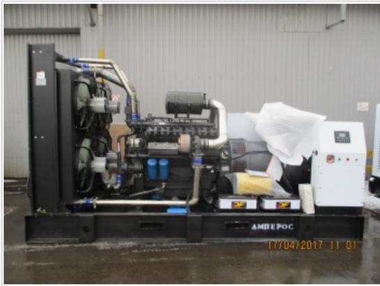
Дизель генератор мощность - 2500 кВА/2000 кВт. Дизель KÖGEL 12V.
