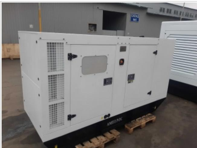
Дизель генератор мощностью 100 кВт/110 кВт в шумозащитном кожухе. Дизель Iveco-FPT(Италия) 1500 об\мин жидкостного охлаждения. Дизель генератор для интенсивной эксплуатации.
