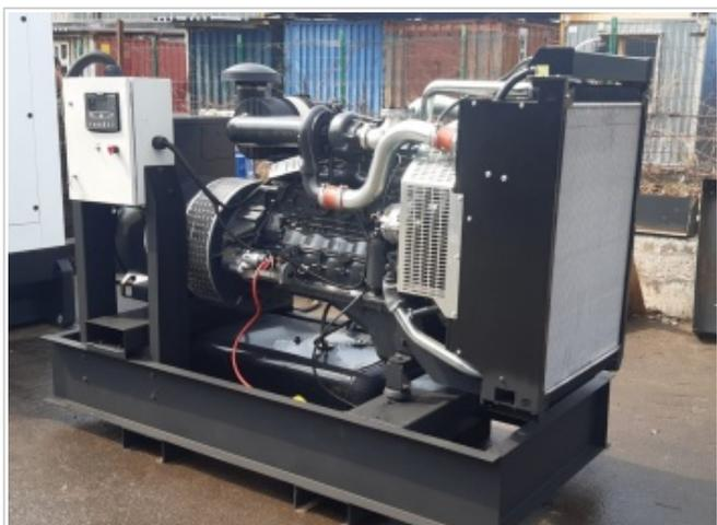
Дизель генератор мощностью 160 кВт/176 кВт. Дизель Iveco-FPT (Италия) 1500 об\мин жидкостного охлаждения. Дизель генератор для интенсивной эксплуатации.
