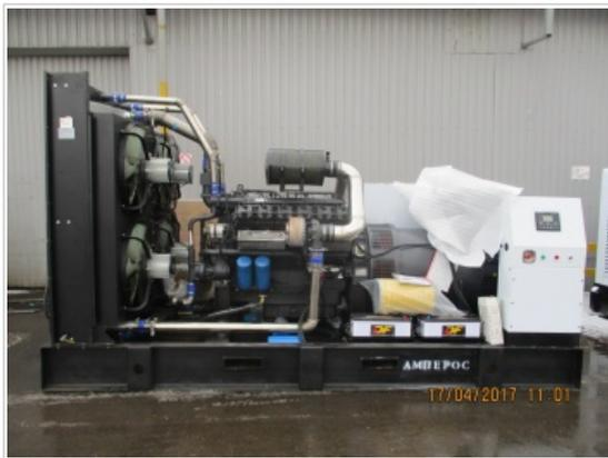
Дизель генератор мощность - 1685 кВА/1350 кВт. Дизель KÖGEL 12V.
