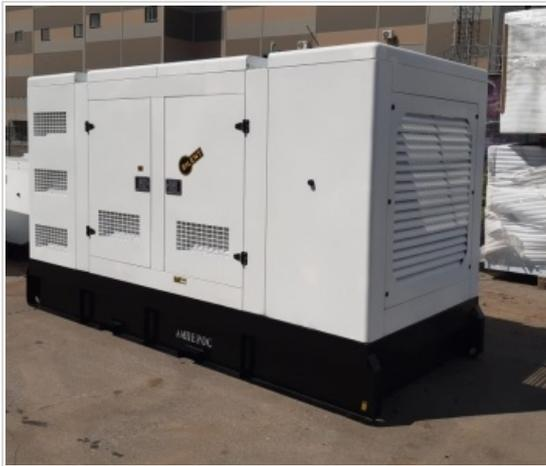
Дизель генератор максимальной мощностью - 480 кВА/380 кВт, основная мощность 440 кВА/350 кВт. Дизель KÖGEL 1500 об/мин 6-цилиндровый.
